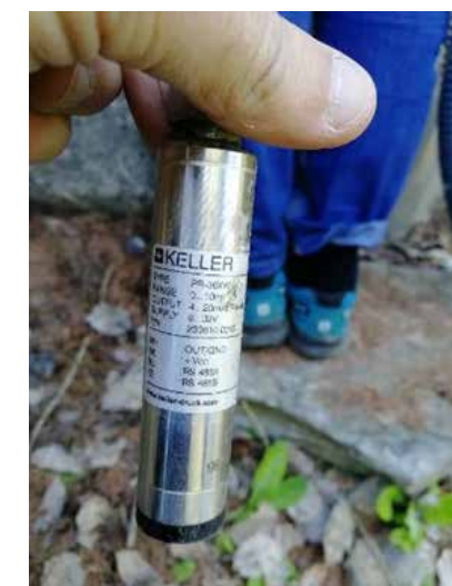
Sensore idrometrico installato all'interno del canale.
